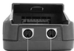
mini-Din C2 测量连接通道C2
